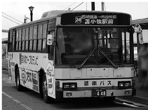
苫小牧港から苫小牧駅前に向かう道南バスは旧苫小牧市交通部の引き継ぎ車両 (日野ブルーリボン KC-HU2MPCA, 1996年式)
